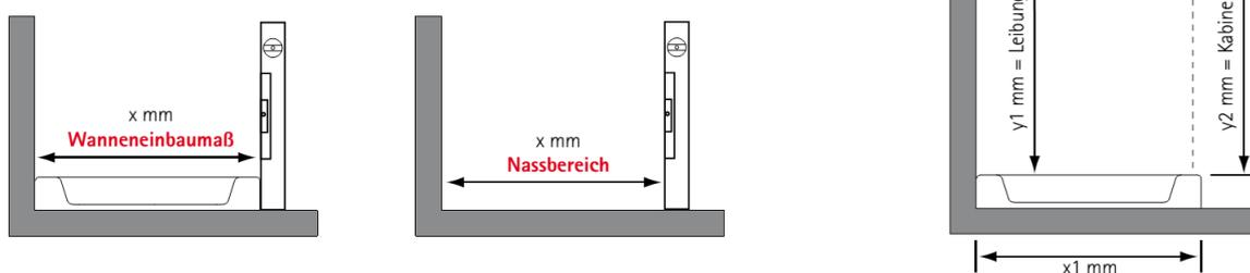
Da HSK-Duschkabinen **standardmäßig** für eine **Montage auf Duschwanne** ausgelegt sind, bitte unbedingt die gewünschte Montagesituation ggf. mit exaktem Maß des Nass- bzw. Fliesenbereichs angeben.
